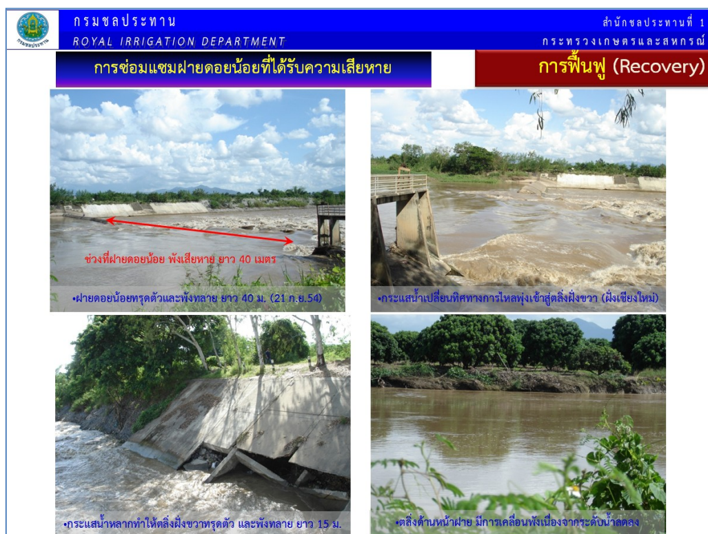
รูปที่ 38 โครงการซ่อมแซมฝายดอยน้อยที่ได้รับความเสียหาย
