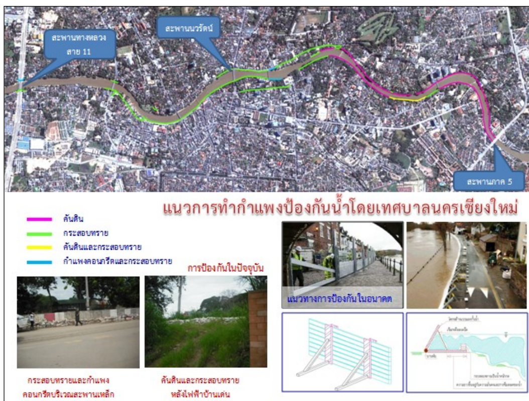
รูปที่ 22 แสดงแผนผังแนวการทำกำแพงป้องกันอุทกภัยจากน้ำปิงเอ่อล้นตลิ่งในเขตเทศบาลนครเชียงใหม่
