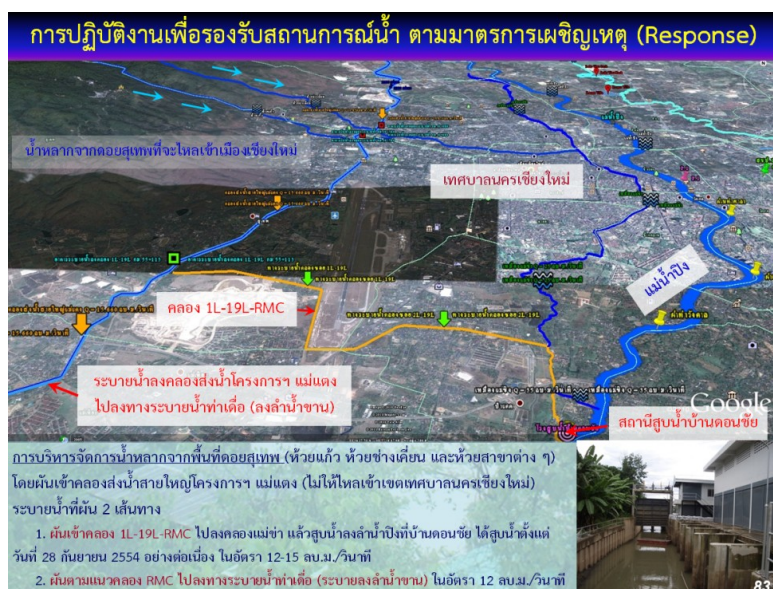
รูปที่ 24 แสดงแนวทางการผันน้ำหลากจากคอกสุเทพเข้าคลองส่งน้ำโครงการฯ แม่แตง เพื่อลดปริมาณน้ำหลากที่ไหลเข้าเขตเทศบาลนครเชียงใหม่
