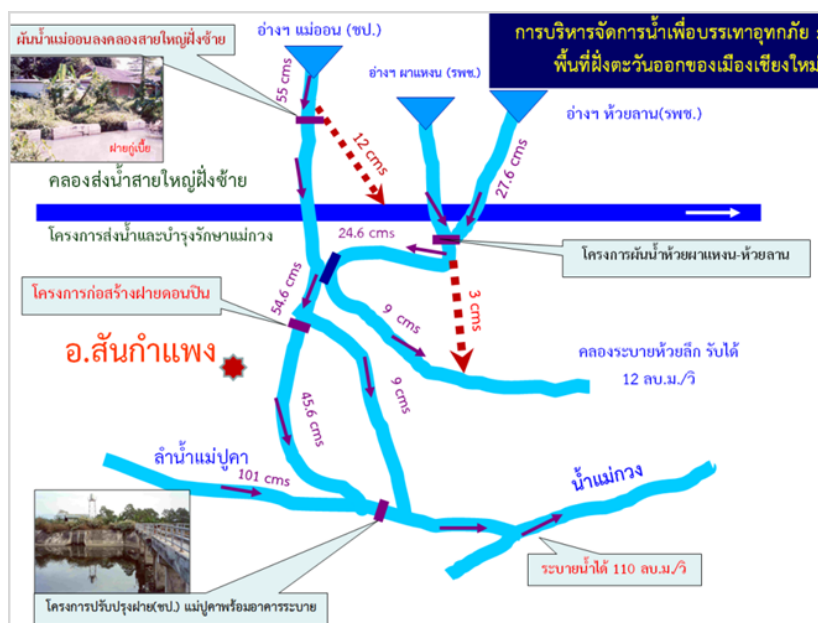
รูปที่ 25 แสดงแนวทางการผันน้ำหลากในพื้นที่ลุ่มน้ำแม่ตอนที่ส่งผลกระทบให้เกิดน้ำท่วมในอำเภอสันกำแพงโดยการผันน้ำจากลำน้ำแม่ตอนเข้าคลองส่งน้ำของโครงการฯ เขื่อนแม่กวงอุดมธารา และทางผันน้ำห้วยลึก
